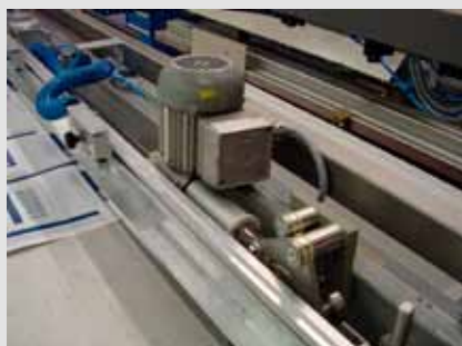
Abb. 8: Motorische Sieblifteinrichtung (Schutzabdeckungen entfernt)
