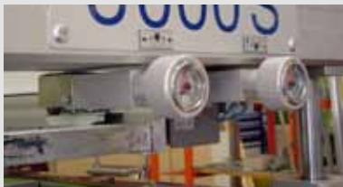
Abb. 7: Mikrometerspindel direkt an der Siebschiene
