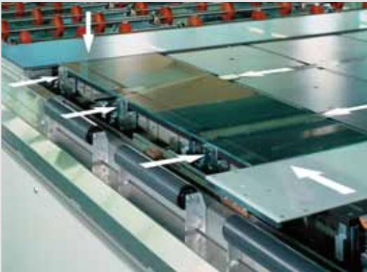
Abb. 4: Vollautomatische Zentrierung gegen feste Anschläge an der Seite
