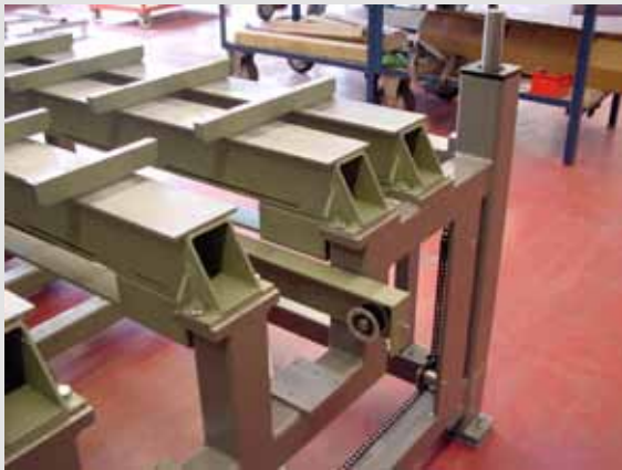
Abb. 2: Geschweißtes, bearbeitetes und verschraubtes Grundgestell Pic 2: Welded, machined and bolted chassis
