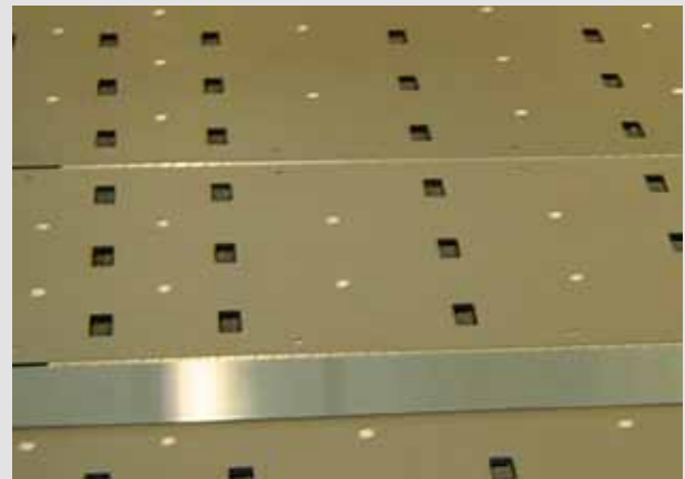
Abb. 3: Drucktisch mit Rollenbett und Luftdüsen Pic.3: Print table with roller bed and air jets
