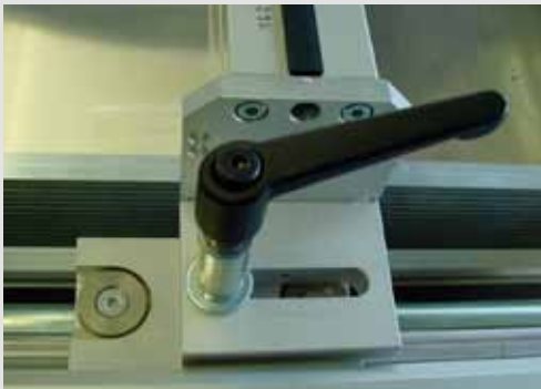
Abb. 10: Diagonalstellung des Rakelwerks
